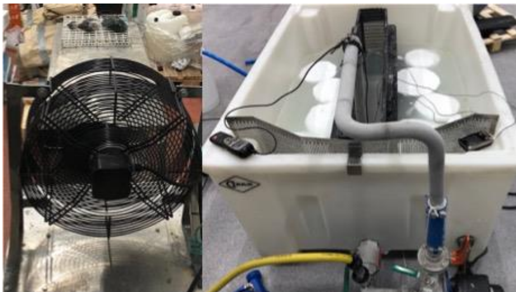
Figur 2 Viser tunnelfryser (venstre) og lakefryser (høyre) brukt i forsøket
